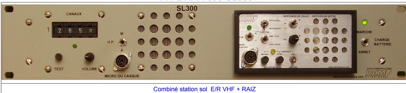
Cet équipement est prévu pour gérer un système émetteur/récepteur externe ou chaîne radio déportée destiné à émettre des messages (enregistrés numériquement) d'information aux aéronefs situés dans les circuits des aérodromes :
